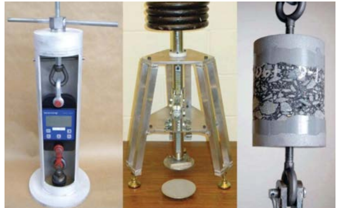
Şekil 2: Kansas, Teksas, and Virginia Çekme Deney Aletleri
